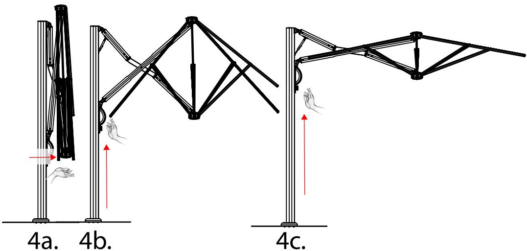
Bloccaggio / sbloccaggio apertura
