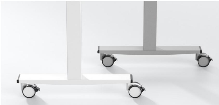
Gamba con montante in tubo d'acciaio di sezione rettangolare 80x60 mm, piede in lamiera piegata 70x30 mm.
